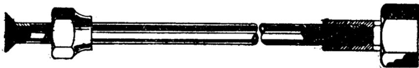
Фиг. 19. Участок трубопровода высокого давления.
