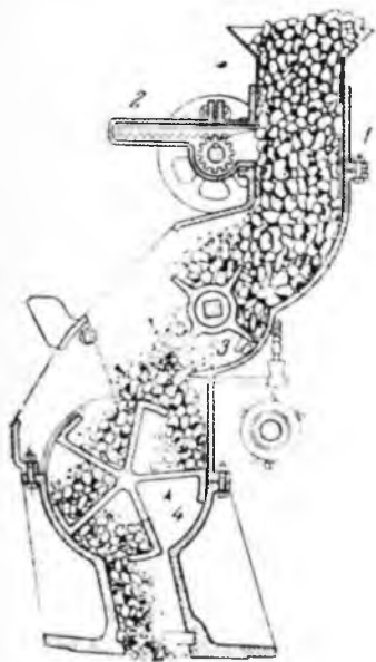
Рис. 51. Схема непрерывного питателя Вельмана:
