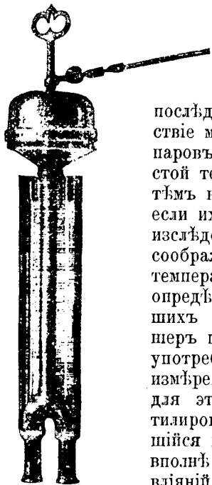
Рис. 71. Аспираціонный психрометръ Ассмана.
