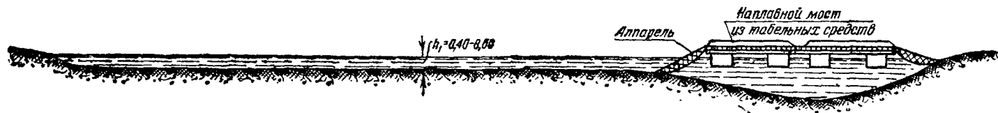
Фиг. 10. Бродо-мостовая переправа с использованием табельных переправочно-мостовых средств
