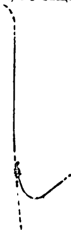
Рис. 18. Траектория пикирующего самолета (сплошная линия) и траектория авиабомбы (пунктиром), сброшенной при пикировании.
