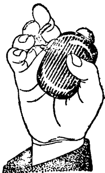
Рис. 261. Магнитоэлектрический фонарь с кремальерой.
