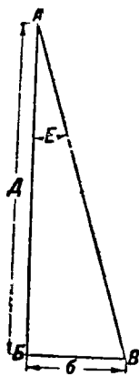
Рис. 199. Дальномерный треугольник. Д — дальность; б — база; Е — параллактический угол.
