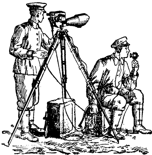
Рис. 36. Общий вид станции оптического телефона.
