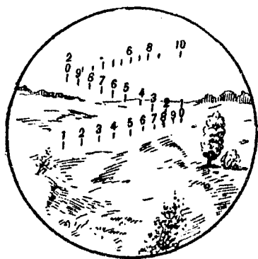
Рис. 204. Поле зрения стереодальномера с постоянной шкалой.
