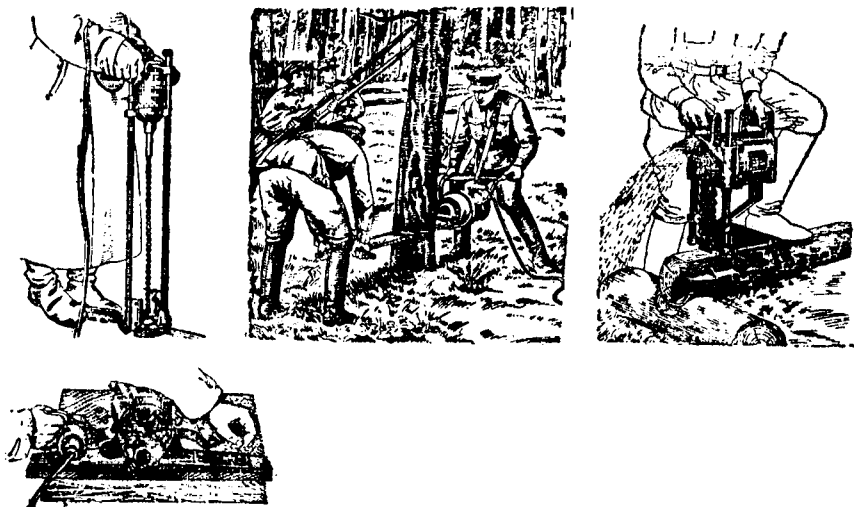
Рис. 287. Электроинструменты: дрель, пила, долото и рубанок.
