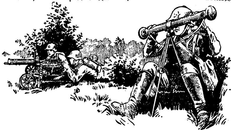
Рис. 202. Монокулярный дальномер с базой 1,25 м.
