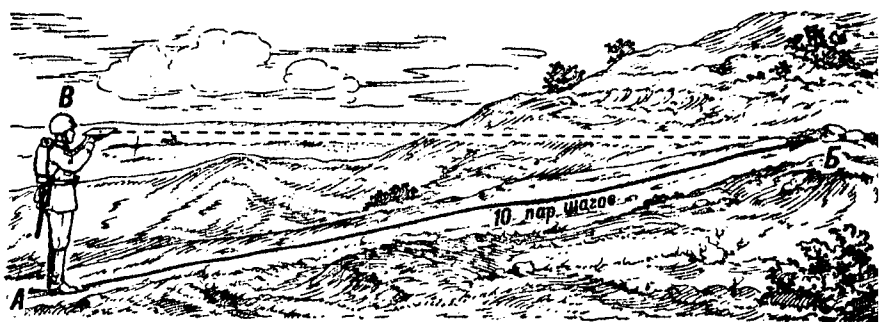
Рис. 61. Определение крутизны ската при помощи папки
