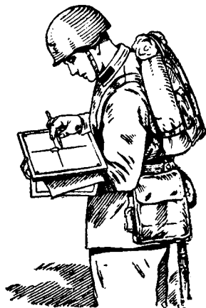
Рис. 160. Отмер и откладывание на планшете удаления предмета от главной вертикали
