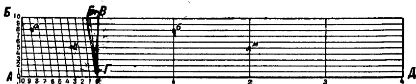
Рис. 21. Поперечный масштаб с основанием в 2 см
