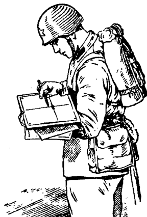
Рис. 159. Отмер и откладывание на планшете удаления предмета от линии горизонта
