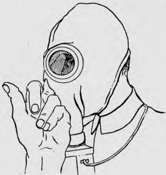
Фиг. 40. Протираие очков с помощью специального отростка „пальца“.
