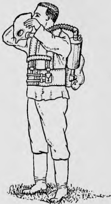
Фиг. 28. Кислородный прибор проф. А. П. Госпелова (надевание).
