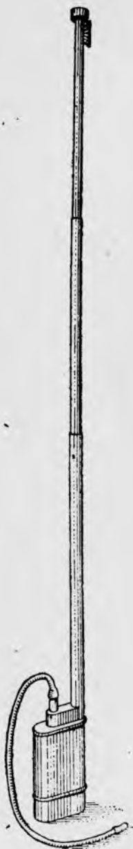
Фиг. 51. Противогаз из жестяных трубок, забирающий воздух из высоких слоев атмосферы.
