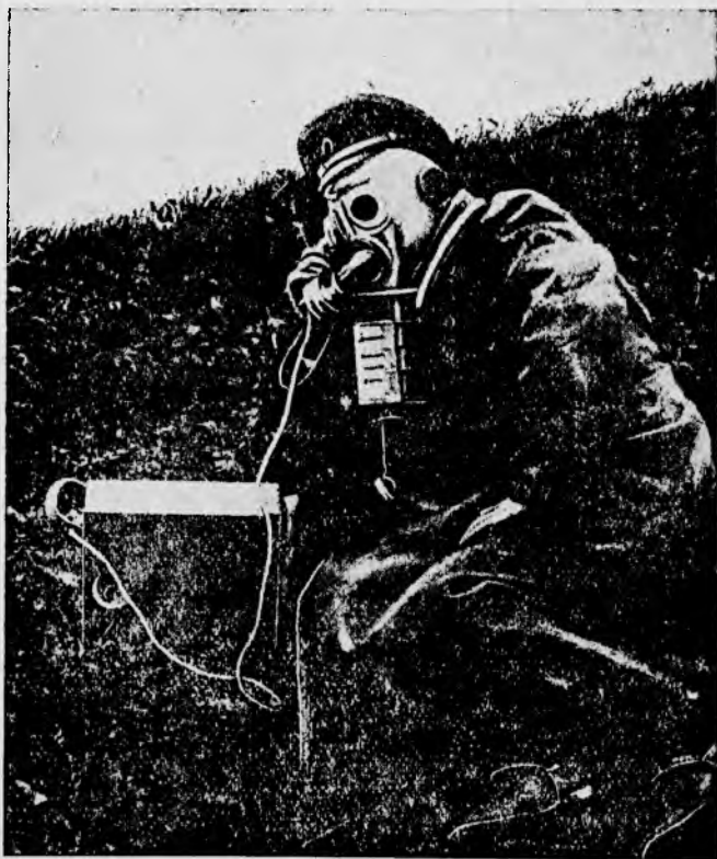
Фиг. 50. Мембрано-маска Бодаревского (разговор по телефону). Из книги "Сведения по военно-хим. делу", 1923 г.
