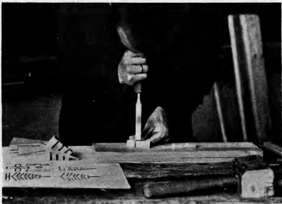
Рис. 206. Зачистка паза въ крестовомъ соединеніи плоской стамезкой.
