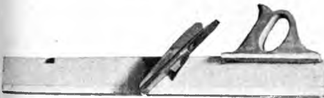
Рис. 74. Разрѣзъ колодки фуганка.
