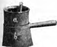
Рис. 50. Мѣдная клеянка. а — сосудъ для клея. в — сосудъ для воды.
