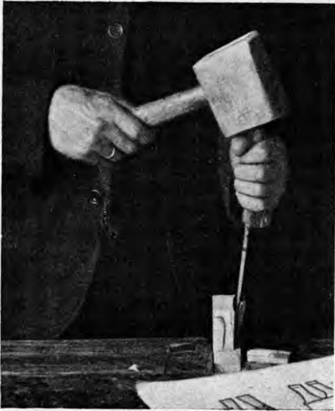
Рис. 192. Грубая обрубка плоской стамезкой ногъ молодца.
