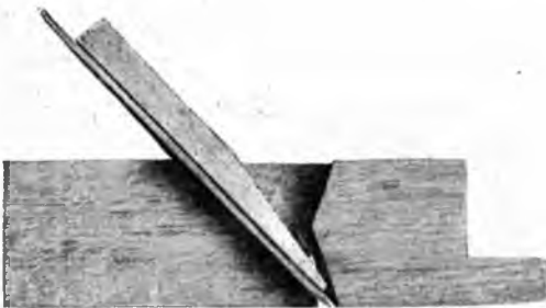
Рис. 61. Разрѣзъ шельхебельной колодки.
