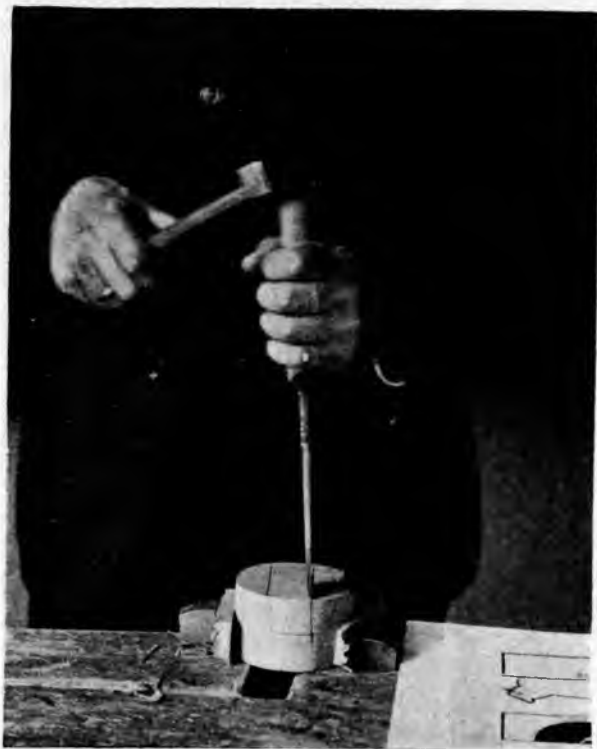
Рис 199. Прорѣзка углубленія въ лукошкѣ для яицъ плоской стамезкой.
