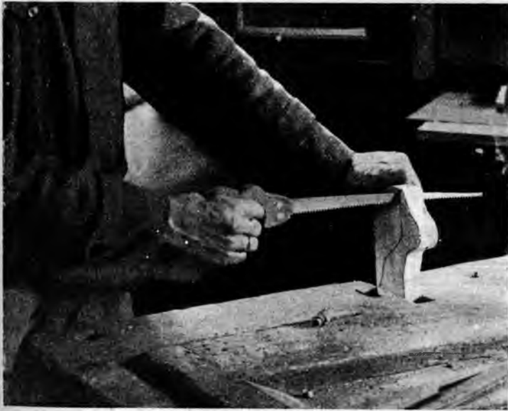
Рис. 133. Пиленіє по кривимъ лініямъ узкої ножовкою.
