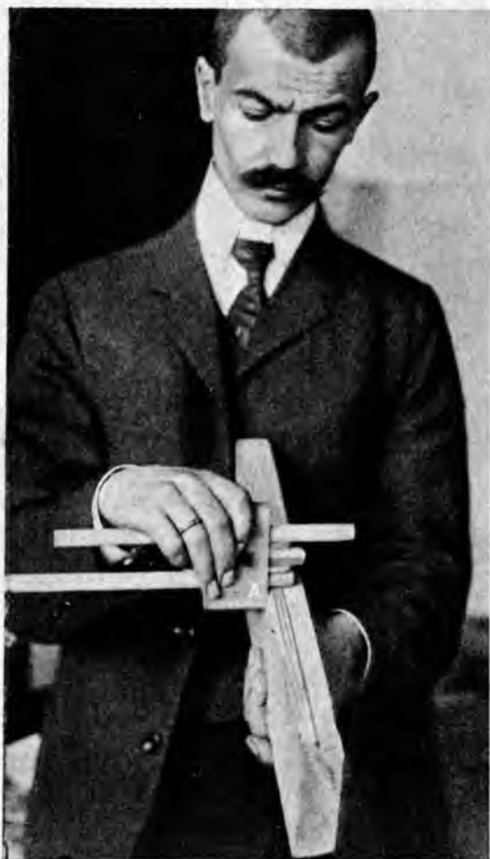
Рис. 80. Какъ надо правильно держать ресмась при работѣ.
