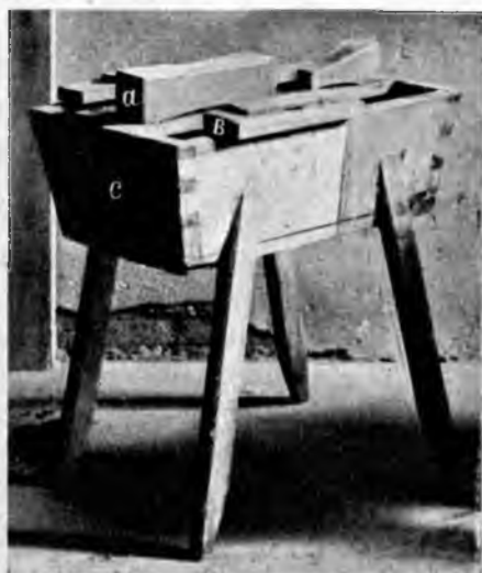
Рис. 49. с — Корыто деревянное. а — брусокъ, в — оселокъ.
