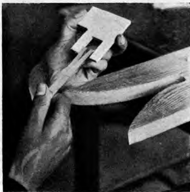
Рис. 211. Проверка пугромъ внутреннихъ размѣровъ стѣнокъ хижны.
