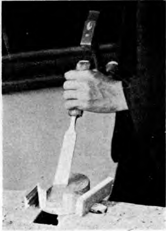
Рис. 200. Долбленіе углубленія для яицъ въ лукошкѣ плоской стамезкой.
