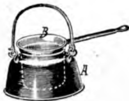
Рис. 51. Чугунная клеянка. А — сосудъ для воды. В — сосудъ для клея.
