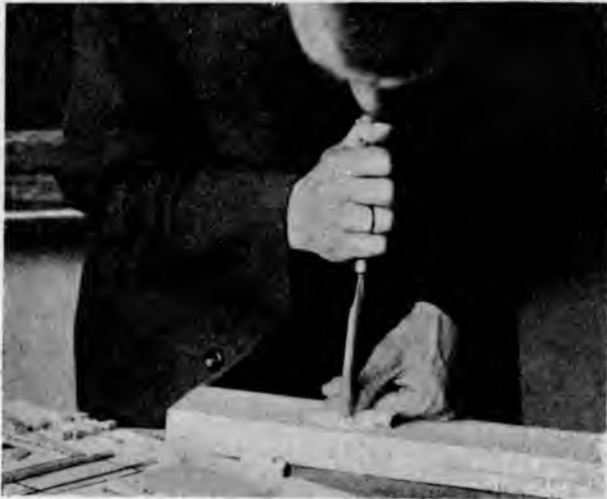
Рис. 214. Отдѣлка коныка на хижину полукруглой стамезкой.
