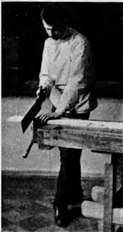
Рис. 127. Правильное положеніе работающаго при пиленіи поперекъ доски широкой ножовкой.
