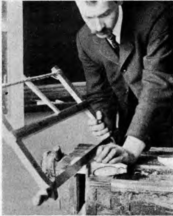
Рис. 191. Пропилъ лучковой пилой-мелкозубкой у конца туловища.
