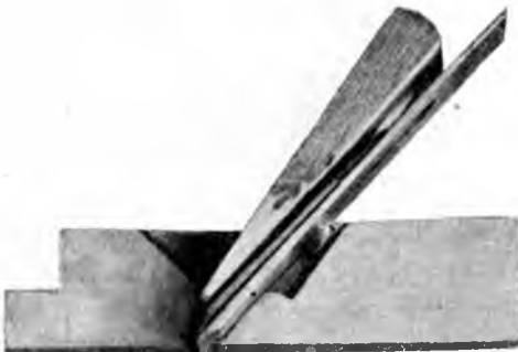
Рис. 66. Разрѣзь колодки двойного рубанка.
