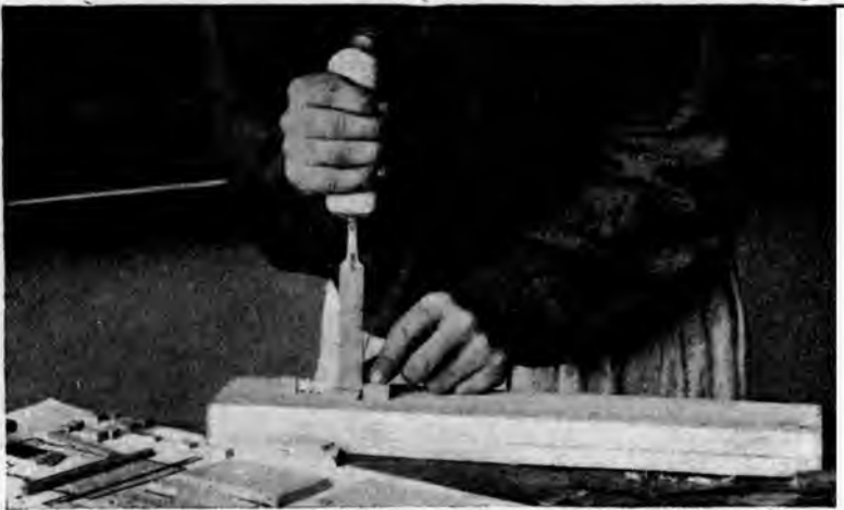
Рис. 213. Отдѣлка украшеній на хижину плоской стамезкой.
