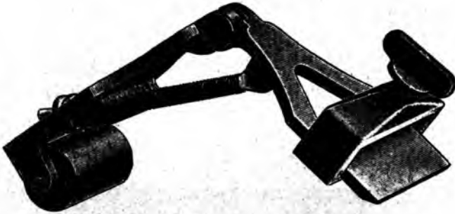
Рис. 157. Приспособленіе для правильнаго затачиванія рѣзущей фаски.
