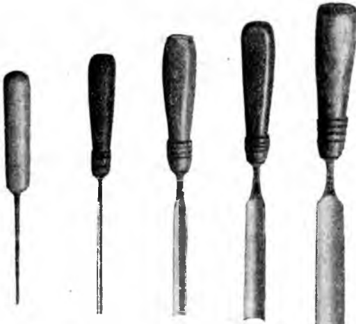
Рис. 24. Боковой видъ на полукруглую стамезку.
