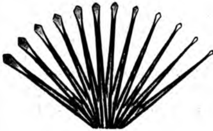
Рис. 93. Комплектъ сверлъ для дрели.
