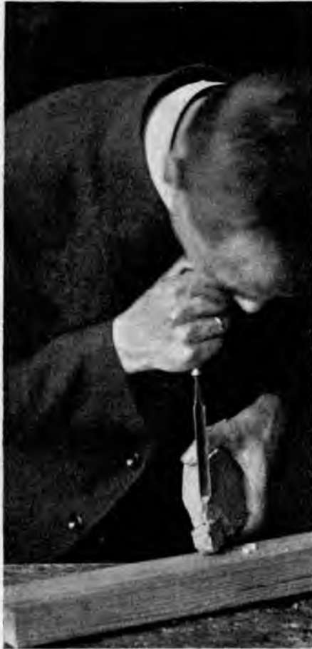
Рис. 196. Окончательная отдѣлка молодца полукруглой стамезкой.
