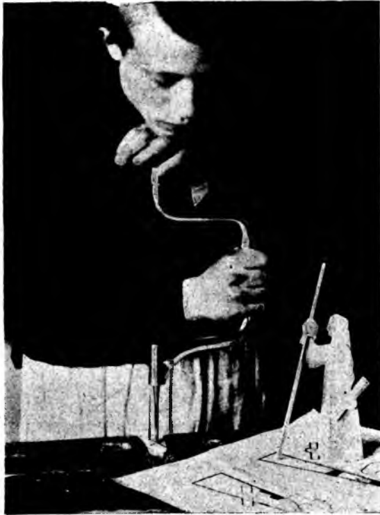
Рис. 190. Просверливаніе дыры въ шаникъ глашатаго коловоротомъ.
