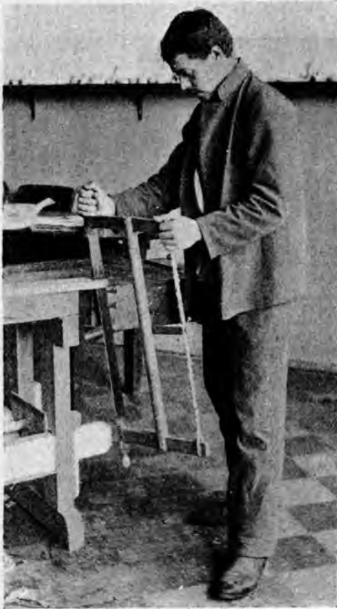
Рис. 131. Пиленіе длиннаго бруска вдоль (въ размахъ).
