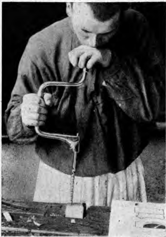
Рис. 201. Просверливаніе коловоротомъ отверстія въ лукошкѣ для рычажка.
