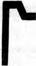
Рис. 6. Желѣзный клинокъ безъ пружины.
