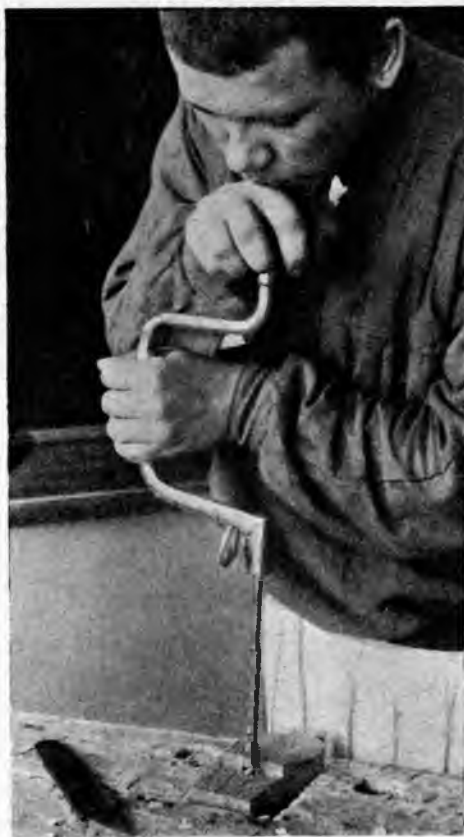
Рис. 193. Просверливаніе отверстія между ногъ коловоротомъ въ точкѣ д (табл. V, рис. 29).
