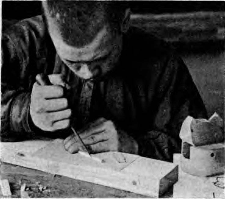
Рис. 202. Обдѣлка отверстія въ палочкѣ для рычага.
