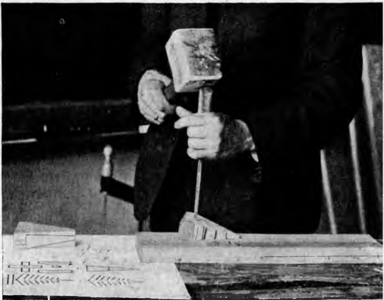
Рис. 205. Выдалбливание этих пропилов плоской стамеской.
