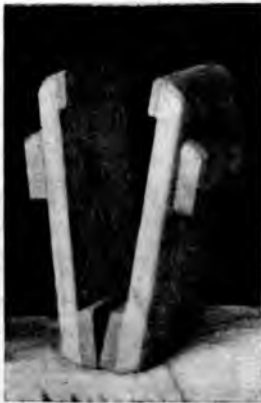
Рис. 108. Тиски для точки и разводки пилъ.
