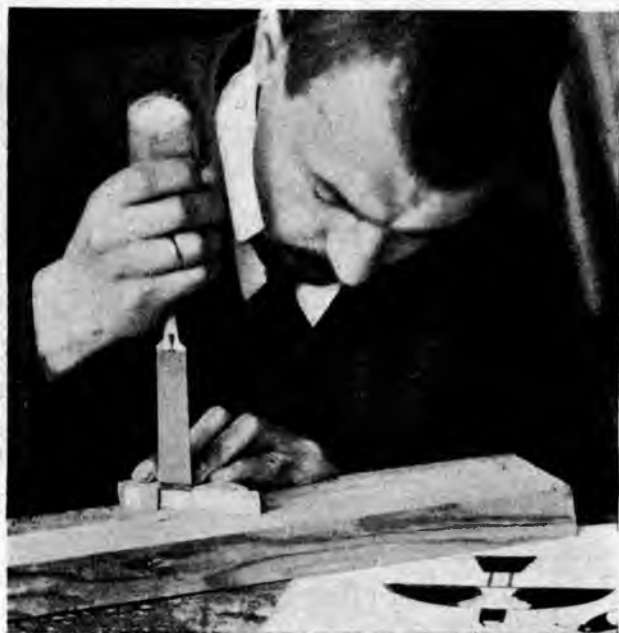
Рис. 208. Зачистка паза для крыльевъ въ летающей птицѣ.
