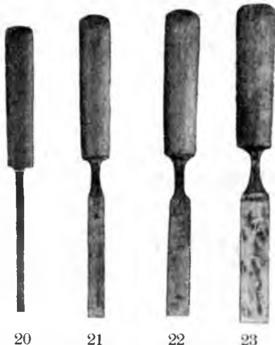
Рис. 20—23. Плоская стамезка въ \frac{1}{4} " , \frac{1}{2} " , \frac{3}{4} " и 1".
