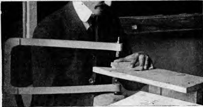
Рис. 219. Запиловка лобзикомъ шпоровъ въ конюшнѣ.
