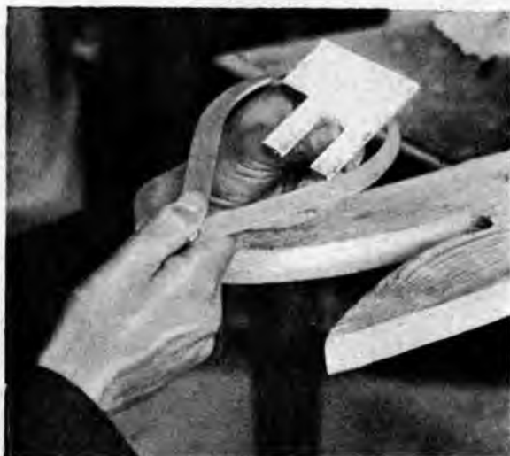
Рис. 210. Проверка кронциркулемъ наружныхъ размѣровъ стѣнокъ хижны.
