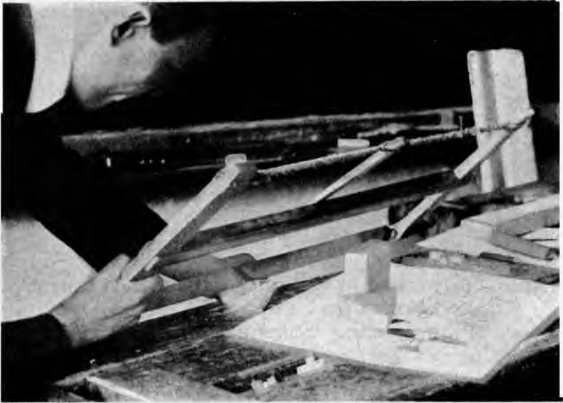
Рис. 204. Пропиливание лучковой пилой промежутков между ветками елки.
