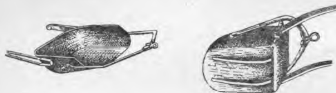
Рис. 36. Конная лопата волокуша емкостью 0,1 м 3 .
