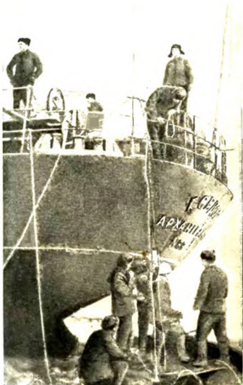
Команда «Г. Седова» ремонтирует руль, поломанный при сжатии льдов. (Лето 1938 г.)
