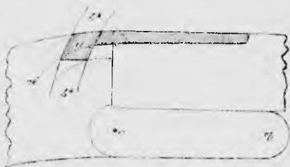
Рис. 63. Верхний затвор Вестли Ричардса.
