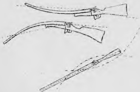
Рис. 121. Колебания ружья при выстреле (размер колебаний для ясности преувеличен).
