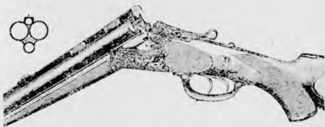
Рис. 64. Четырехстволка с Гринеровским болтом.
