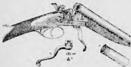
Рис. 61. Английский не пружинный затвор.
