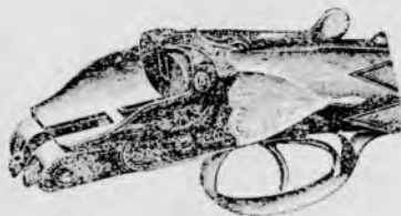
Рис. 60. Колодка с приливами.
