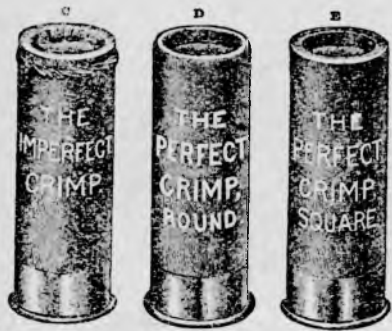
Рис. 125. Закрученные гильзы: С—плохо, D и E—хорошо.
