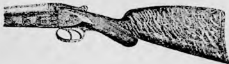
Рис. 108. „Рациональная“ ложа Гринера.
