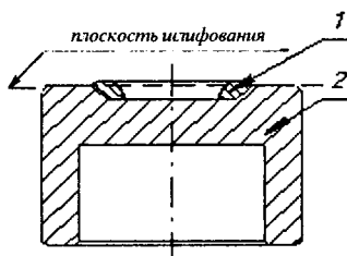
Рис. 1. Эскиз наплавленной заготовки матрицы (1- наплавленный металл, 2- основной металл)
