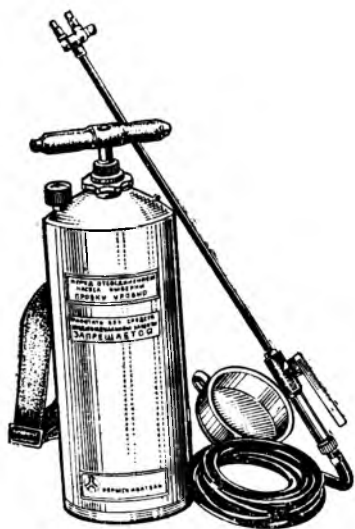
Рис. 3. Опрыскиватель ОС-76 (ранцевый пневматический)
