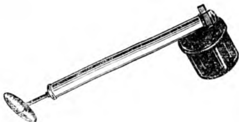
Рис. 7 Опрыскиватель ОР-0,25 (пневматический ручной)
