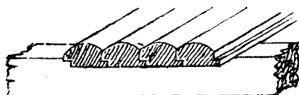
Простильный потолокъ изъ пластинъ.
