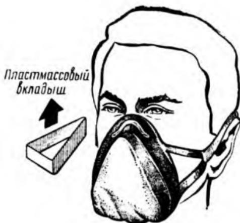
Рис. 4. Противоаэрозольный респиратор «Кама»
