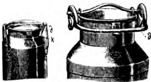
Рис. 28. Острыцы затворовъ молочныхъ флягъ. На рисункахъ изображены два рычажныхъ затвора; съ обоихъ затворахъ крышка поднимается посредствомъ дужекъ д , пломба или замокъ можетъ надѣваться на колечко к .
