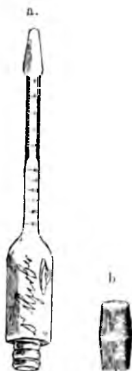
Рис. 20. а) Бутирометрическая трубка для опредѣленія жира по способу Гербера. б) Резиновая пробка для бутирометрической трубки.
