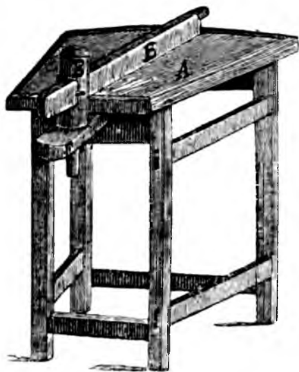
Рис. 39. Простѣйшій маслообработникъ. А. — Треугольный столъ съ наклономъ къ заднимъ ножкамъ. Б. — Свободно поднимающійся и опускающійся брусъ, укрѣпленный на вращающемся столбикѣ В.
