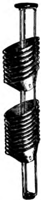
Рис. 33. Тарелки, изъ которыхъ составляется барабанъ въ сепараторѣ «Альфа-Лаваль».
