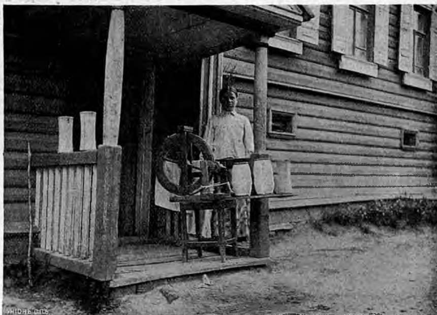
Рис. 8. Приборъ для размотки пряжи въ Кинешемскомъ уѣздѣ Костромской губ.
