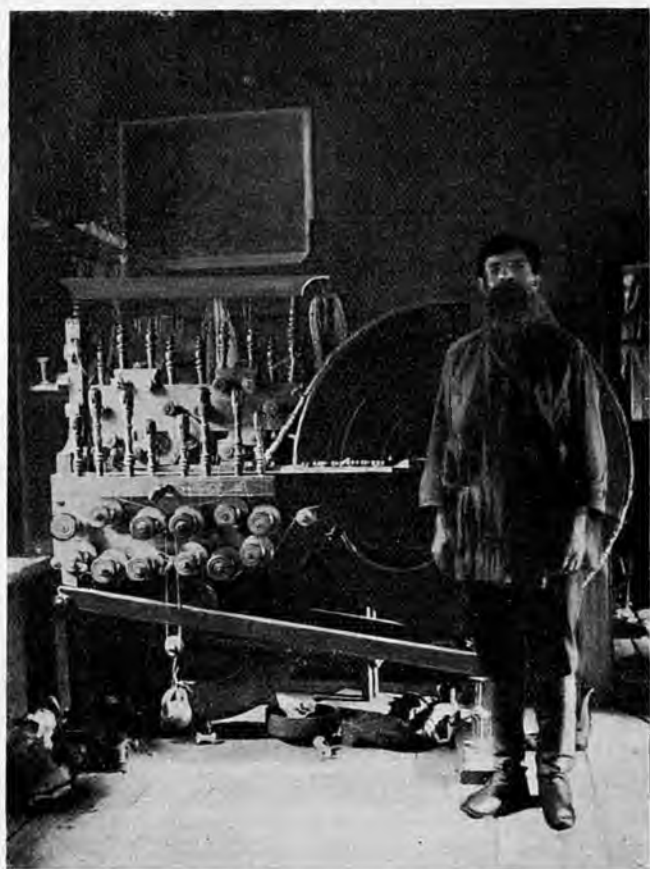
Рис. 18. Крутильный станокъ для приготовленія „прядева“.
