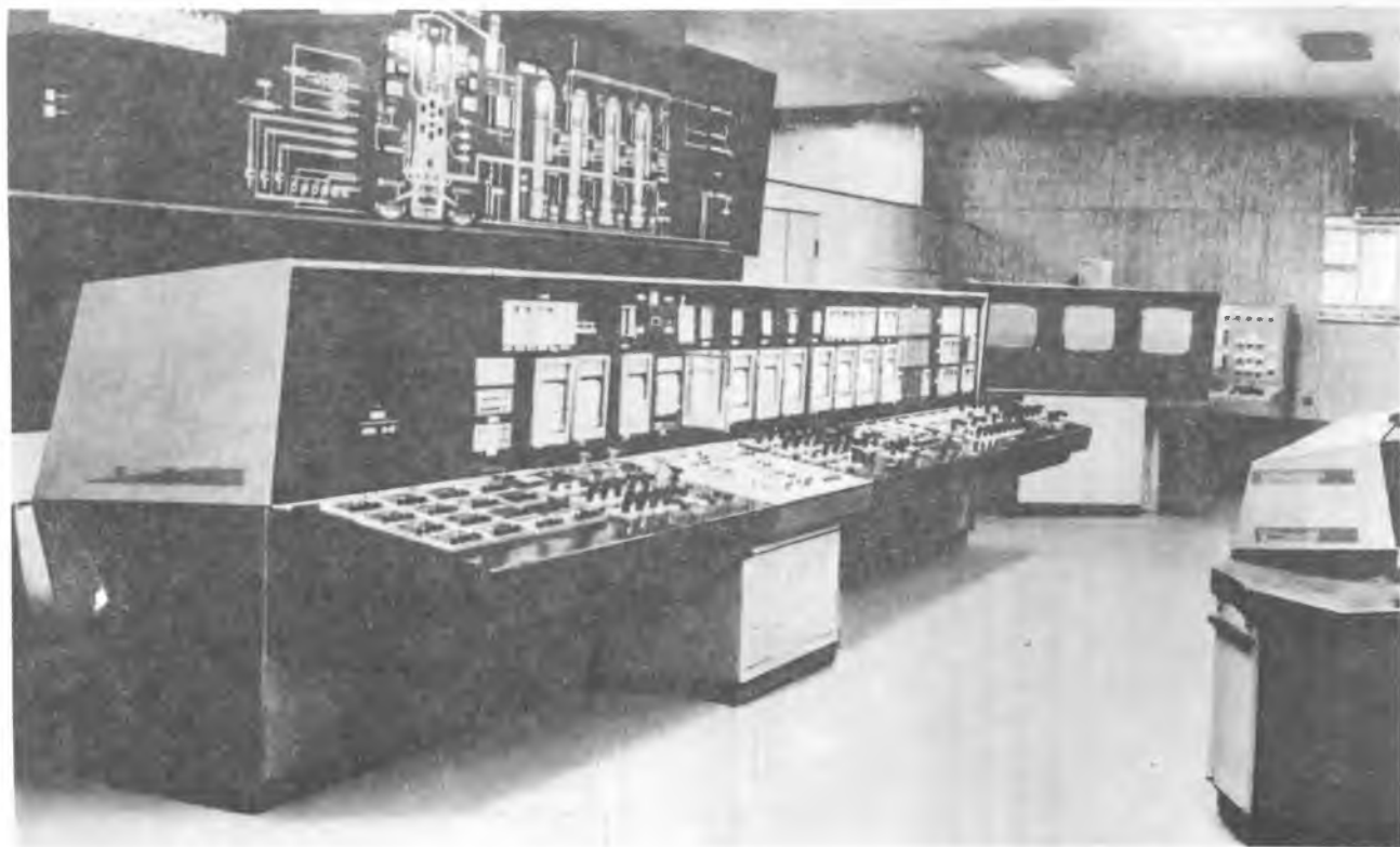
Рис. 2.10. Центральный пост управления доменной печью
