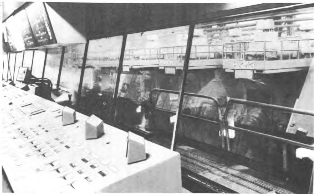
Рис. 4.15. Пульт управления чистовой группой клеток стана
