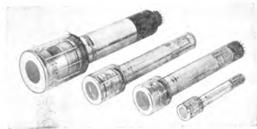
Суперортиконы — высоко- чувствительные передаю- щие трубки
