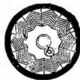
Рис. 25. Ручной сепаратор Мелотт. Цилиндр со вставками. Горизонтальный разрез.
