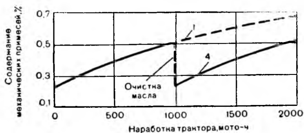
Рис. 26. Изменение загрязненности масел, используемых в гидросистеме и трансмиссии трактора Т-150К:
