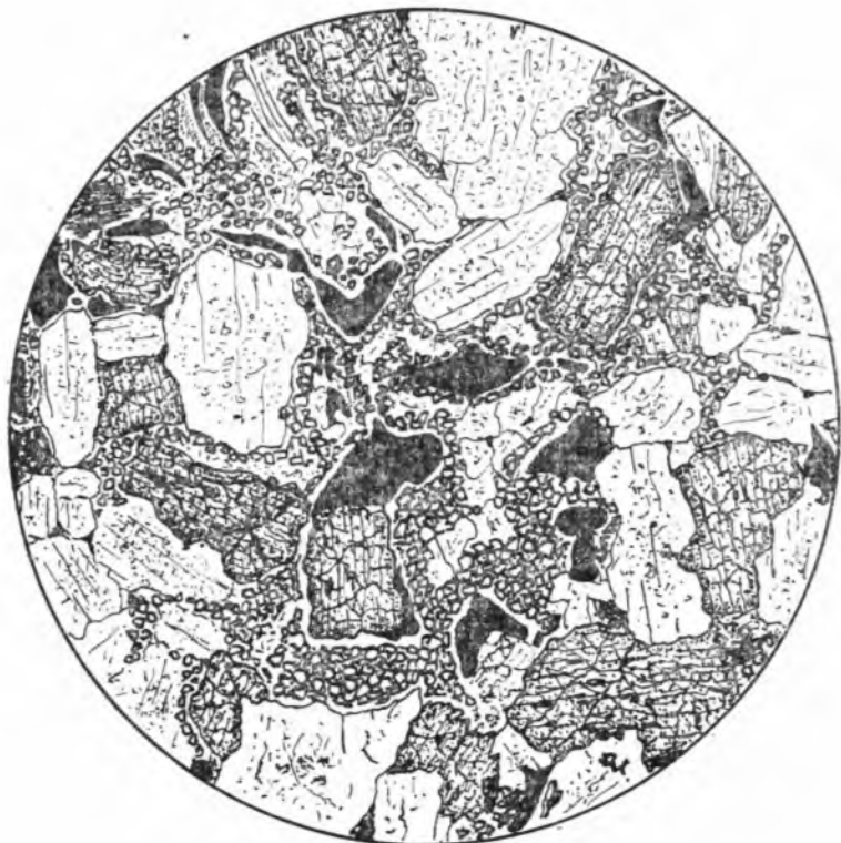
Рис. 10. Образование граната и магнетита на границах ортопироксена с плагиоклазом. Пироксен-плагиоклазовая порода. Р. Енисей, обр. 3876/1938. Николи ||, увел. 11. Зарисовка с микрофотографии.
