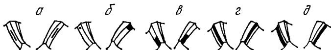
Рис. 13. Положение пятна контакта на рабочих поверхностях зуба ведомой шестерни главной передачи, соответствующих движению автомобиля передним и задним ходом:
