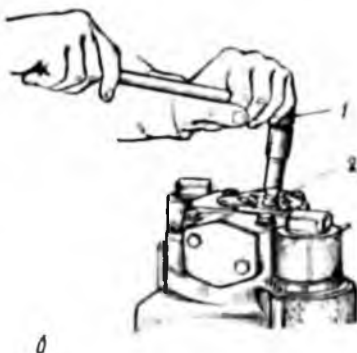
Рис. 16. Замена насоса подпитки и обратных клапанов:
