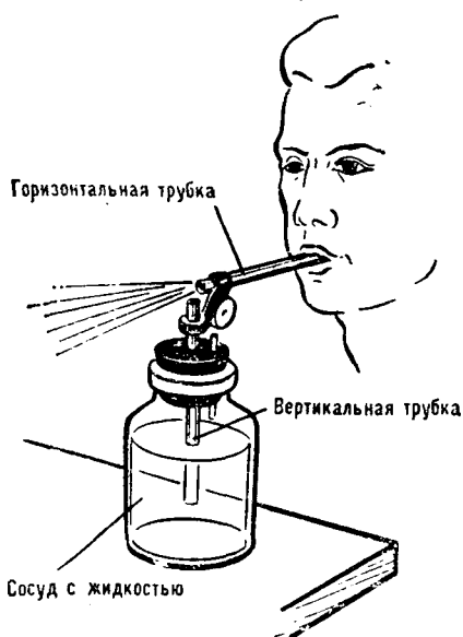
Рис. 34. Принцип действия пульверизатора
