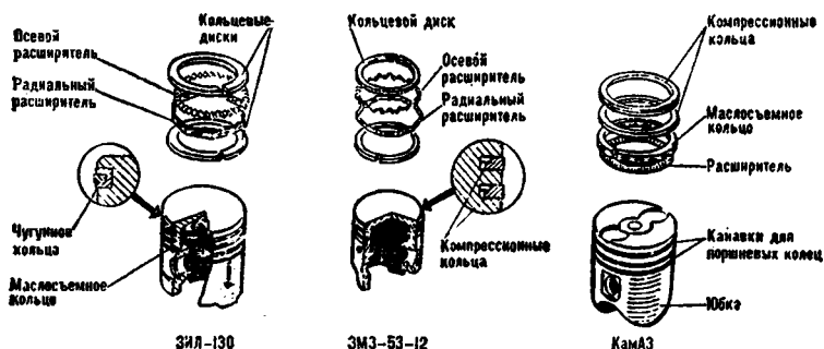
Рис. 7. Поршни и поршневые кольца
