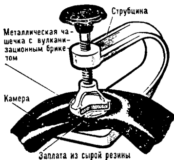
Рис. 198. Вулканизация камеры
