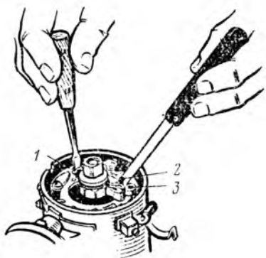
Рис. 77. Регулировка зазора между контактами прерывателя: 1 — эксцентрик; 2 — контакт; 3 — винт
