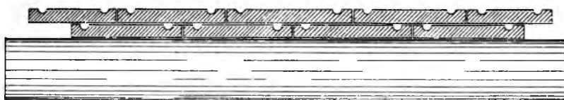
Рис. 27. Поперечный разрѣзъ части крыши въ „карту“.
