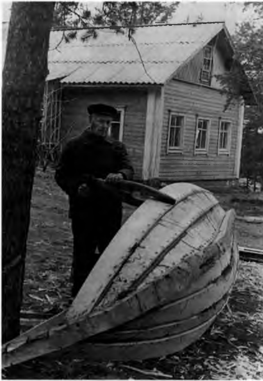
Рис. 45. Изготовление – “шитье” лодки. Мастер П. Ремщув, д. Вокнаволок Калевальского района (фото Ю. Сурхаско, 1991 г.)
