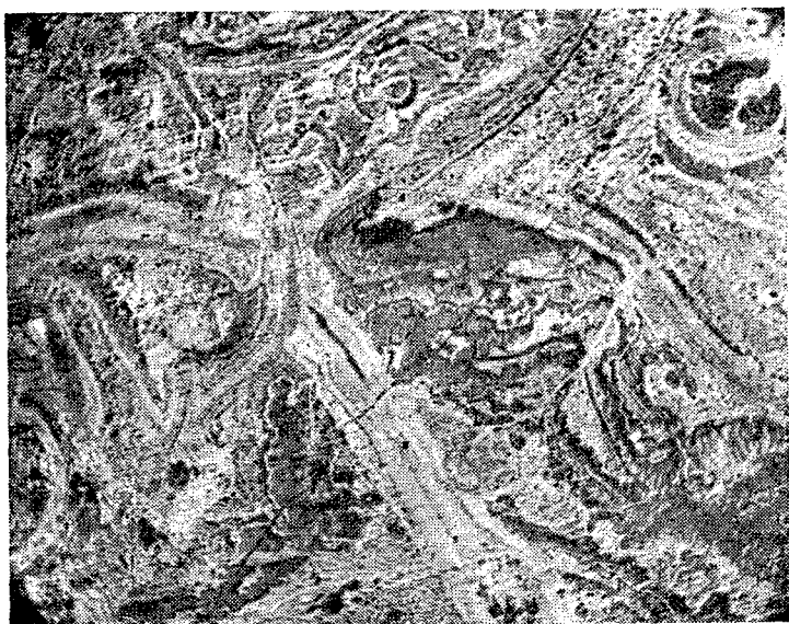
Рис. 3. Микроструктура окалины \text{Fe}_2\text{O}_3 при увеличении 300
