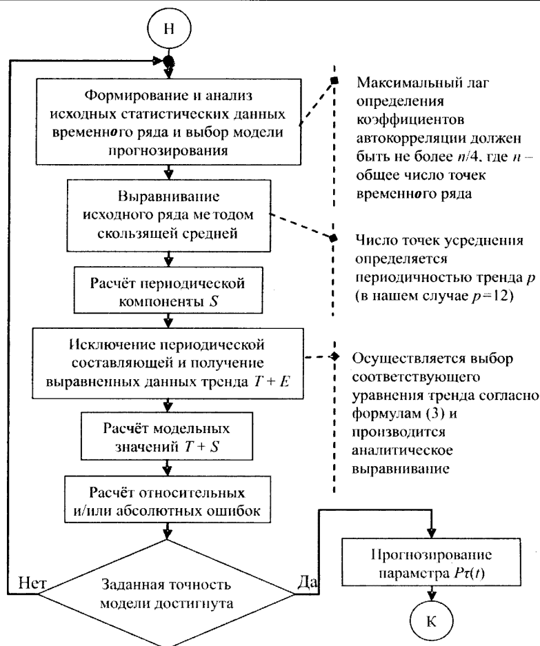
Рис. 2. Алгоритм решения задачи прогнозирования нагрузки потребителей на основе автокорреляционной модели
