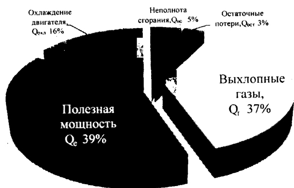
Рис. 1. Тепловой баланс дизельного двигателя
