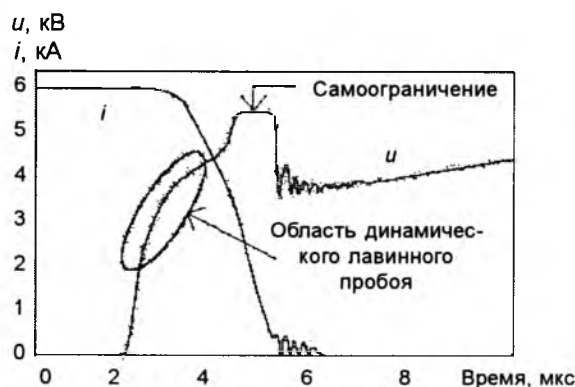
Рис. 7. Процесс отключения прибора IGCT с площадью активной области 40 \text{ см}^2 в пределах зоны безопасной работы без демпфирующей цепи
