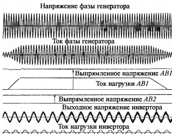
Рис.5. Напряжения и токи ЭЭС при набросе и сбросе нагрузки в канале системы электродвижения
