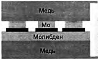
Рис.3. Поперечный разрез классической мультичиповой прижимной технологии: каждый чип воспринимает усилие сжатия прибора, делённое на число чипов
