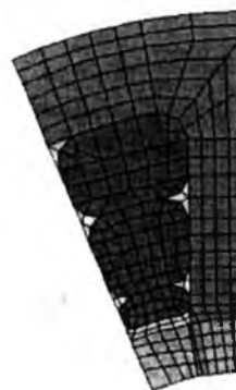
Рис.2. Сеточная модель полупериода дискретной структуры статора герметичной индукторной машины
