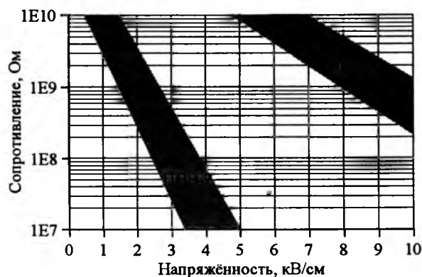
Рис. 2. Зависимость поверхностного электрического сопротивления эмалей от напряженности
