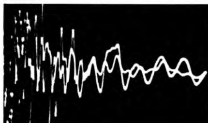
Рис. 1. Распределение радиальных напряжений по высоте обмотки НН (а, 1 – среднее; 2 – критическое), изменение в НВИ-осциллограммах (б), деформация в виде потери радиальной устойчивости обмотки НН (в) трансформатора 6300 кВ·А
