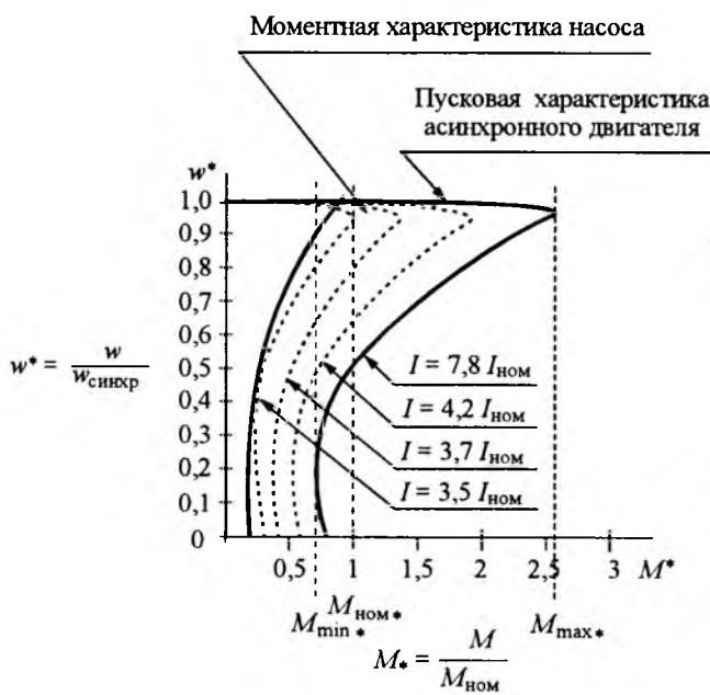
Рис.8. Механическая характеристика МНА
