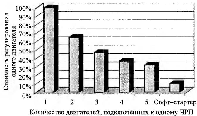
Рис.2. Зависимость стоимости регулирования одного двигателя от числа управляемых от одного ЧРП
