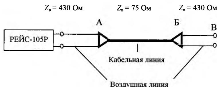
**Рис.3. Схема воздушной линии с кабельной вставкой:**
