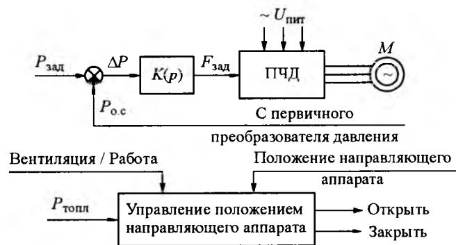
Рис.2. Структурная система управления электроприводом дымососа
