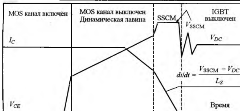
Рис.2. Характеристики ОБР выключения IGBT с режимом самоограничения SSCM
