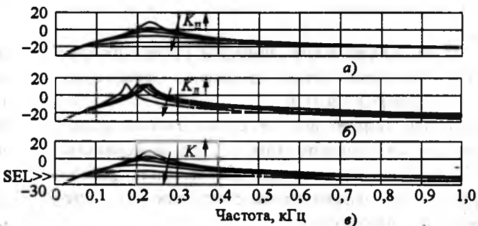
Рис.6. Зависимость I_c/U_c от частоты для пропорционального K_n (а), дифференциального K_{др} (б) и пропорционально-дифференциального K(1+L_{ср}) законов регулирования (топология рис.2,в), K_n = K_{др}/L_c = K = 0,1, 0,5, 1, 2, 5 , входной сигнал I_c
