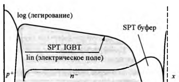
Рис.3. Сечение легирования IGBT технологии SPT и распределение поля
