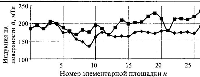
Рис.2. Распределение индукции B на поверхности ротора электродвигателя 5ДВМ215 по элементарным площадкам после намагничивания в холодном и горячем состояниях:
