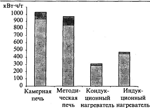
Рис.4. Сравнение потребления конечной энергии в кузнечном производстве при нагреве одной тонны стали в различных печах [1]:
