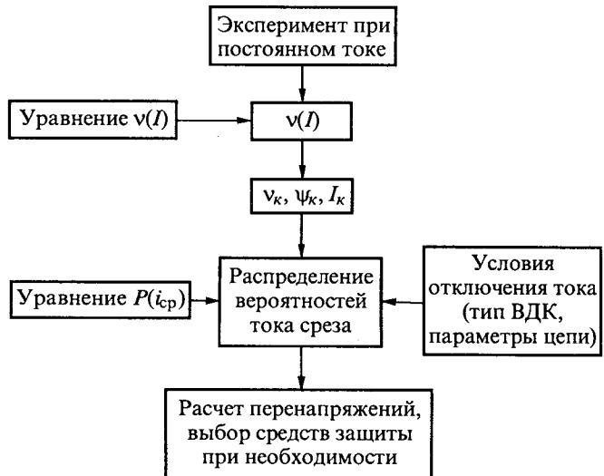
Рис.6. Последовательность определения распределения вероятностей тока среза при отключении тока в вакууме
