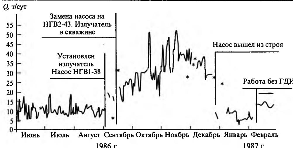
Рис.8. Результаты эксплуатации нефтяной скважины № 1666 Мулымьинского месторождения Шаимского района с излучателем (пропуски означают, что ПАТ не производил замеров дебита; \* – отдельные замеры дебита)
