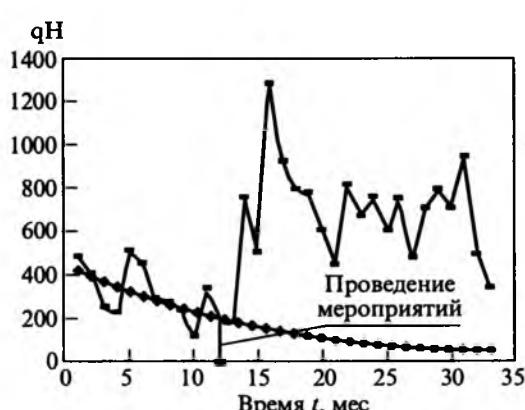
Рис.5. График среднемесячной добычи окружающих скважин на участке месторождения Дружное (г.Когалым, Россия) до и после обработки скважин:
