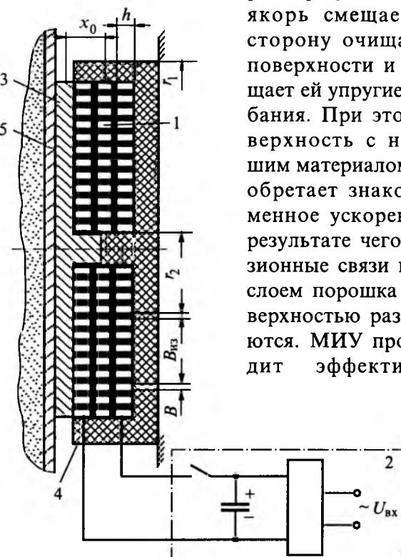
Рис.1. Конструктивная схема МИУ
