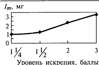
Рис.3. Износ токосъемных щеток при разных уровнях искрения
