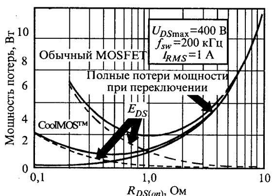
Рис.11. Зависимости энергии  $E_{DS}$  и полных потерь мощности при переключении от  $R_{DS(on)}$  для транзистора CoolMOS™ и обычного MOSFET
