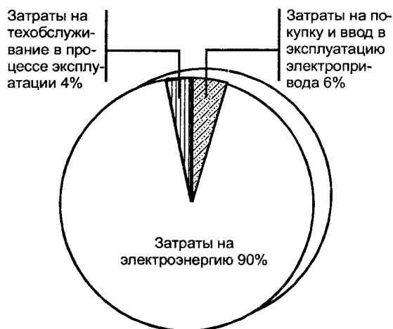
Рис.1. Типичное распределение затрат на мощный высоковольтный электропривод по схеме вентильного двигателя в процессе эксплуатации
