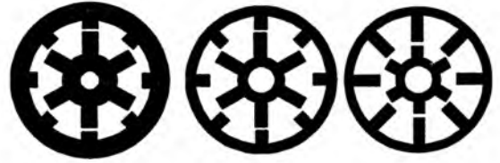
Рис.2. Поперечные сечения ВИМ при варьировании диаметра ротора и фиксированном значении диаметра статора
