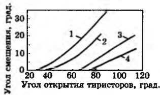
Рис.3. Зависимость угла смещения от угла открытия тиристорov: 1 — \omega=0,979 ; 2 — \omega=0,995 ; 3 — \omega=0,6 ; 4 — \omega=0
