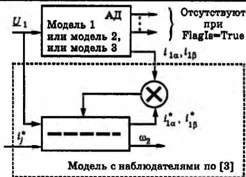
Рис.2. Бездатчиковый измеритель частоты вращения с наблюдателем по [3] и с моделью объекта по [1]
