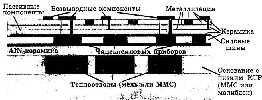
Рис.11. Интеллектуальный силовой модуль MMC
