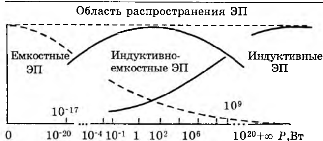
Рис.1. Предпочтительные области распространения электромеханических преобразователей энергии
