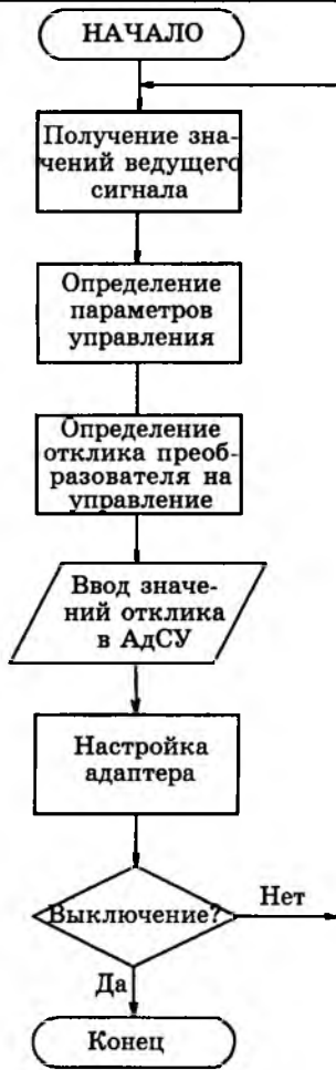
Рис.2. Алгоритм функционирования адаптивной системы управления
